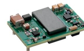
直流—直流(DC—DC)转换器
