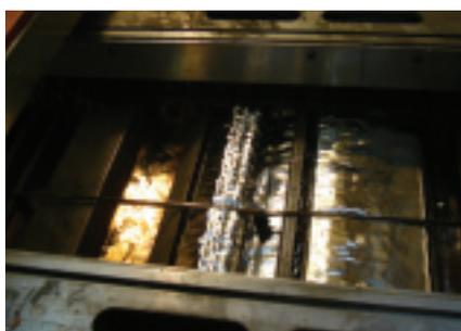
LFはんだのフロープロセス用のはんだ槽
