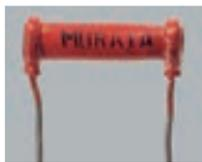
チタン酸バリウム磁器コンデンサ
